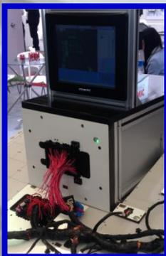
导通回路测试+继电器电性能
