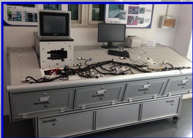
保险丝影像系统可以集成到测试台上，加上继电器电性能测试，可以同时完成线束的所有电性能测试。
